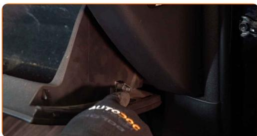
**3** Lösen Sie die Befestigungsclips der Innenraumfilterabdeckung.
