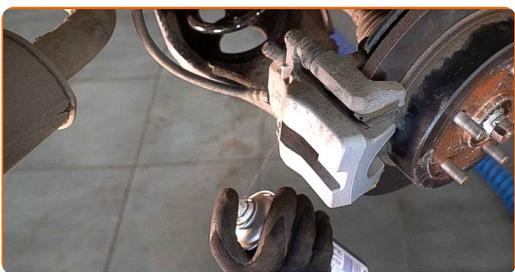
9 Schrauben Sie die Befestigung des Bremssattels ab. Verwenden Sie Stecknuss Nr. 14. Verwenden Sie ein Windeisen.
