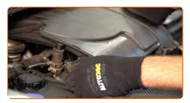
Trennen Sie das Luftansaugrohr vom Luftfilter-Gehäuse.
