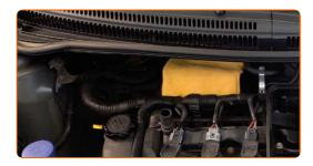
Entfernen Sie das Filterelement aus dem Filtergehäuse.
