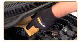
Setzen Sie die Luftfilterabdeckung ein. Befestigen Sie diese.
