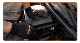
Bringen Sie die Befestigungsklemmen der Entlüftungsleitung des Luftfilters und der Zuleitung des Luftfilters an. Verwenden Sie Schlauchklemmenzangen mit Arretierung.
