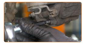
Installieren Sie die Staubschutzkappen der Bremssattel-Führungsstifte.
