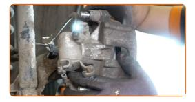
Ziehen Sie die Bremssattelbefestigungen fest. Verwenden Sie Inbusschlüssel Nr. H7. Verwenden Sie einen Drehmomentschlüssel. Ziehen Sie ihn mit 34 Nm Drehmoment fest.
