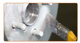
Die Bremsscheibenoberfläche reinigen. Benutzen Sie einen Bremsenreiniger.
