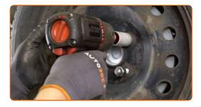
Senken Sie das Auto und ziehen Sie die Radschrauben über Kreuz an. Verwenden Sie eine Schlagnuss für Felgen # 21. Verwenden Sie einen Drehmomentschlüssel. Ziehen Sie ihn mit 103 Nm Drehmoment fest.
