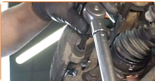
**31** Installieren Sie die Staubschutzkappen der Bremssattel-Führungsstifte.
