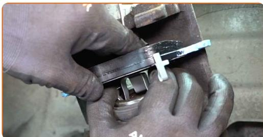
**29** Installieren Sie den Bremssattel und fixieren Sie diesen.
