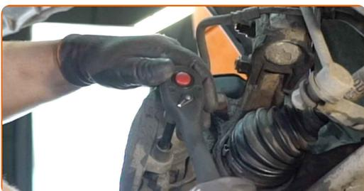
**9** Lösen Sie die Bremssattel-Haltefeder. Benutzen Sie ein Brecheisen.
