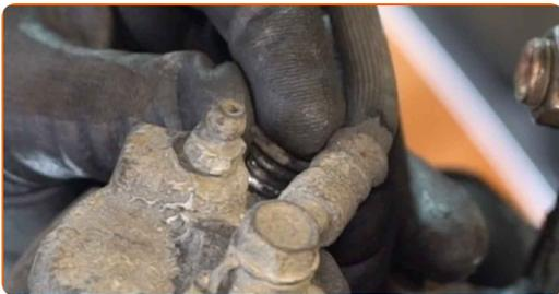
**32** Bauen Sie die Bremssattel-Haltefeder ein. Benutzen Sie ein Brecheisen.
