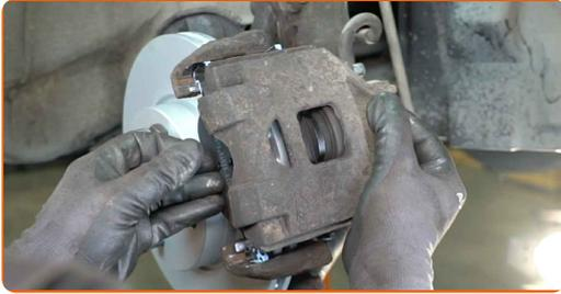
**30** Ziehen Sie die Bremssattelbefestigungen fest. Verwenden Sie Inbusschlüssel Nr. H7. Verwenden Sie einen Drehmomentschlüssel. Ziehen Sie ihn mit 34 Nm Drehmoment fest.
