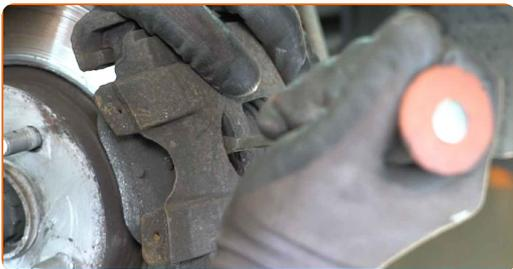
**11** Entfernen Sie den Bremssattel. Benutzen Sie ein Brecheisen.
