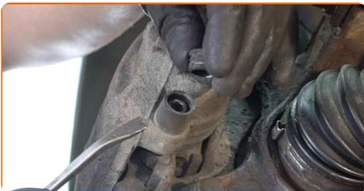
**8** Schrauben Sie die Befestigungen des Bremssattels ab. Verwenden Sie Inbusschlüssel Nr. H7. Verwenden Sie einen Ratschenschlüssel.
