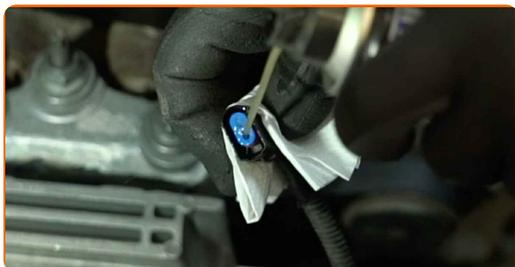
**20** Schließen Sie den Stecker des ABS-Sensors an.
