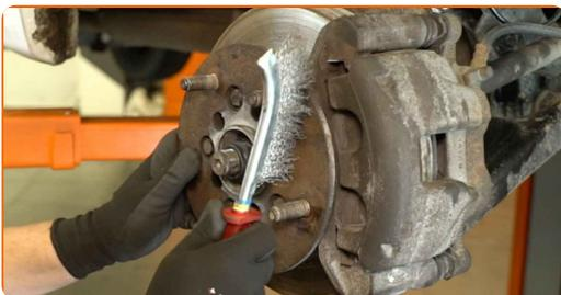
**22** Reinigen Sie die Oberfläche der Radnabe, die die Felge berührt. Verwenden Sie Keramikfett.
