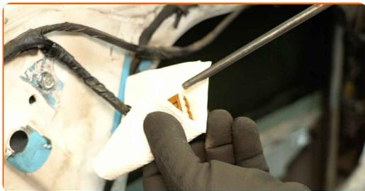
**27** Verbinden Sie den Stecker mit dem Schalter des elektrischen Fensterhebers.
