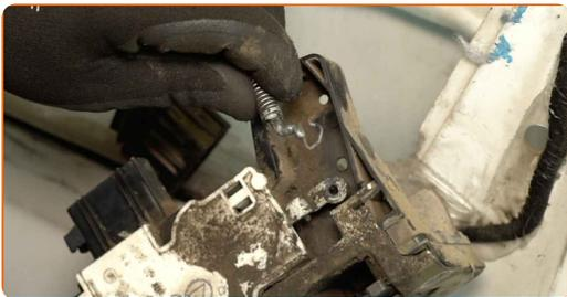
**16** Reinigen Sie den Stecker des Türschlosses. Verwenden Sie ein Elektronikspray.
