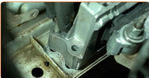
**12** Ziehen Sie die oberen Befestigungsmutter des Motorlagers fest. Verwenden Sie eine Stecknuss mit einem Durchmesser von 18 mm. Verwenden Sie einen Drehmomentschlüssel. Anzugsdrehmoment: 115 N·m.
