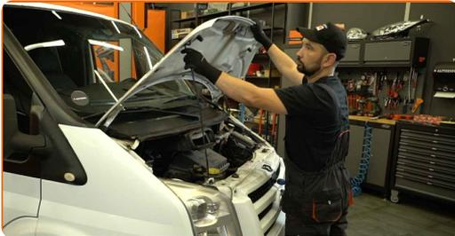
**2** Verwenden Sie einen Kotflügelshoner, um Schäden am Lack und den Kunststoffteilen des Autos zu verhindern.
