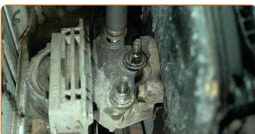
**8** Entfernen Sie das Motorlager.
