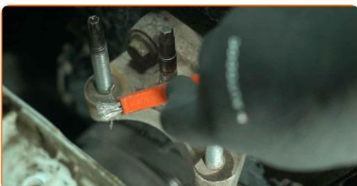
**10** Setzen Sie ein neues Motorlager ein.
