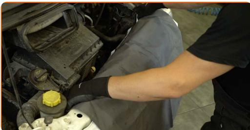
**3** Reinigen Sie die Befestigungselemente des Motorlagers. Benutzen Sie eine Drahtbürste. Verwenden Sie WD-40-Spray.
