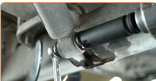
**10** Entfernen Sie die Befestigungsbolzen.
