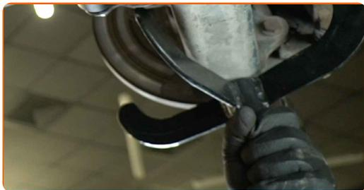
**19** Reinigen Sie die Aufnahme der Radfelge. Benutzen Sie eine Drahtbürste. Verwenden Sie ein Allzweck-Reinigungsspray.
