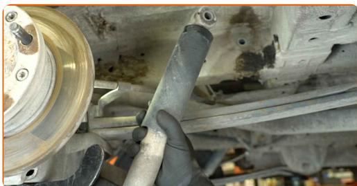
**12** Reinigen Sie die Aufnahmen des Stoßdämpfers. Benutzen Sie eine Drahtbürste. Verwenden Sie ein Allzweck-Reinigungsspray.
