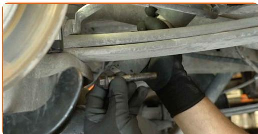
**11** Entfernen Sie den Stoßdämpfer.
