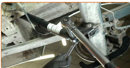
**17** Ziehen Sie die obere Befestigungsmutter des Stoßdämpfers fest. Verwenden Sie einen Ringmaulschlüssel mit einem Durchmesser von 18 mm. Verwenden Sie eine Stecknuss mit einem Durchmesser von 21 mm. Verwenden Sie einen Drehmomentschlüssel. Anzugsdrehmoment: 180 N·m.
