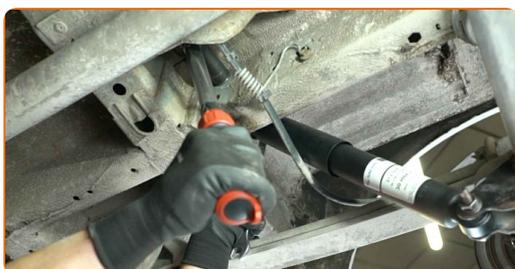
**18** Entfernen Sie die Stütze unter dem Achsträger.
