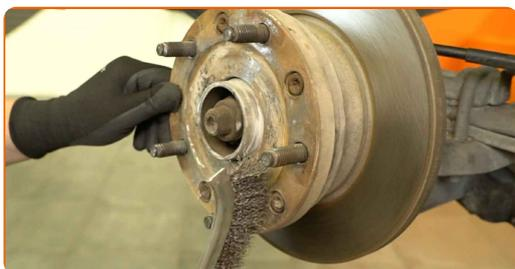
**20** Reinigen Sie die Oberfläche der Radnabe, die die Felge berührt. Verwenden Sie Keramikfett.
