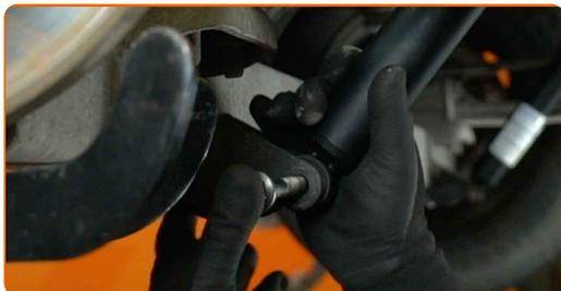
**15** Um die Bolzen und Muttern richtig anzuziehen, müssen Sie die Aufhängung aufbocken, um sie zu belasten. Verwenden Sie einen Getriebeheber, wenn das Fahrzeug auf einer Hebebühne angehoben wurde.
