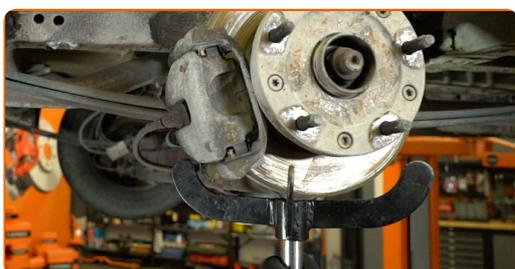
**16** Ziehen Sie die untere Befestigungsmutter des Stoßdämpfers fest. Verwenden Sie einen Ringmaulschlüssel mit einem Durchmesser von 15 mm. Verwenden Sie eine Stecknuss mit einem Durchmesser von 18 mm. Verwenden Sie einen Drehmomentschlüssel. Anzugsdrehmoment: 80 N·m.
