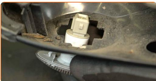
**8** Setzen Sie den Zusatzblinker in einen neuen Außenspiegel ein.
