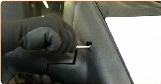
**12** Schrauben Sie die Befestigungsschrauben des Außenspiegels ein. Verwenden Sie eine Stecknuss mit einem Durchmesser von 8 mm. Verwenden Sie einen Ratschenschlüssel.
