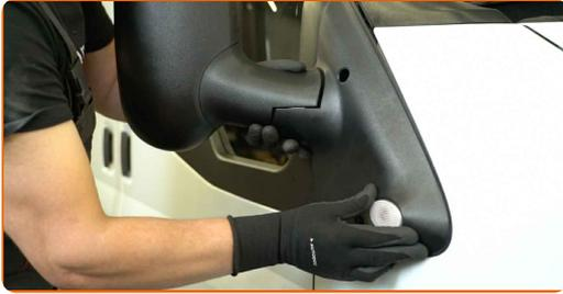
**11** Setzen Sie die Befestigungsschrauben ein.
