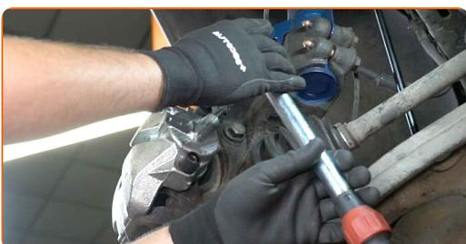
**23** Installieren Sie die Staubschutzkappen der Bremssattel-Führungsstifte.
