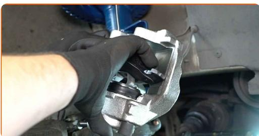
**22** Installieren Sie den Bremssattel und fixieren Sie diesen. Verwenden Sie Inbusschlüssel Nr. H7. Verwenden Sie einen Drehmomentschlüssel. Ziehen Sie ihn mit 30 Nm Drehmoment fest.
