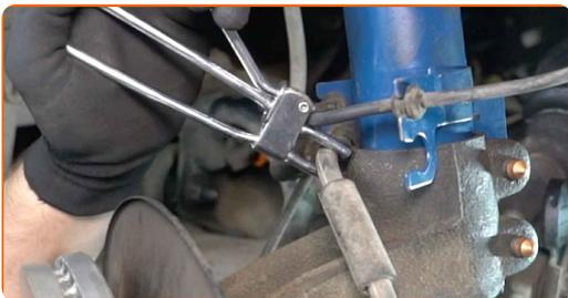
**11** Reinigen Sie den Bereich, in welchem der Bremsschlauch an den Bremssattel angeschlossen ist, sowie den Bereich der Führungsbolzen. Benutzen Sie eine Drahtbürste. Benutzen Sie einen Bremsenreiniger.
