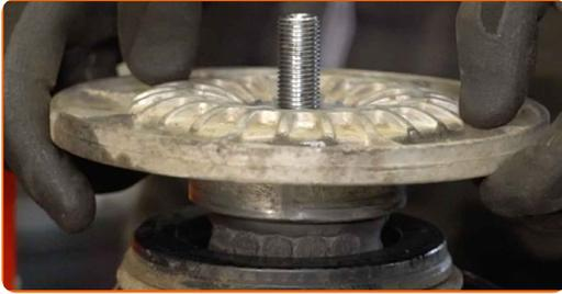
49 Ziehen Sie die Federbeinkolbenstangenmutter an. Verwenden Sie Stecknuss Nr. 21. Verwenden Sie Inbusschlüssel Nr. H7. Verwenden Sie einen Drehmomentschlüssel. Ziehen Sie ihn mit 80 Nm Drehmoment fest.
