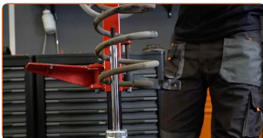
45 Installieren Sie die Feder am Stoßdämpfer.
