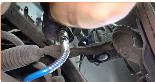
32 Entfernen Sie die Befestigungsschrauben.
