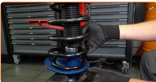
**53** Reinigen Sie die Anbringungssitze des Federbeins. Benutzen Sie eine Drahtbürste. Benutzen Sie WD-40-Spray.
