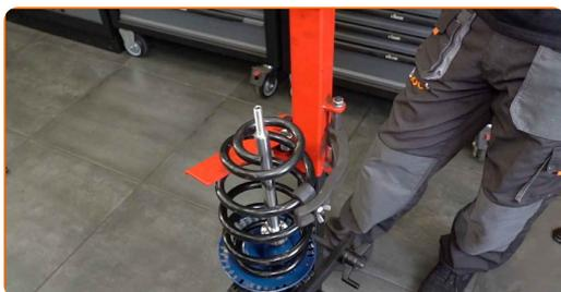
47 Installieren Sie die Manschette und eine Stoßstopp auf den Stoßdämpfer.
