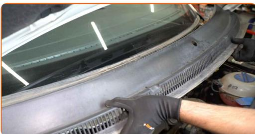
85 Bauen Sie die Dichtung der Windabweiserabdeckung ein.
