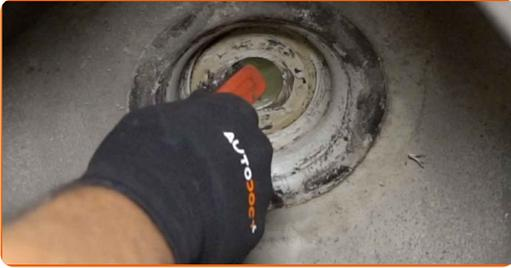
**54** Installieren Sie das Federbein am Radlauf.
