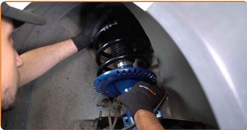
**55** Schrauben Sie die obere Befestigung des Domlagers an. Schrauben Sie diese nicht fest.
