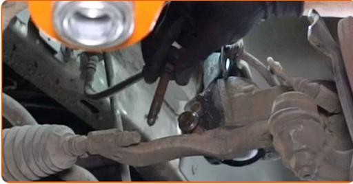
33 Lösen Sie das untere Befestigungselement, dass das Federbein mit dem Achsschenkel verbindet. Verwenden Sie eine spezielle Schraubnuss, um den Stoßdämpfer zu entfernen. Verwenden Sie einen Ratschenschlüssel.
