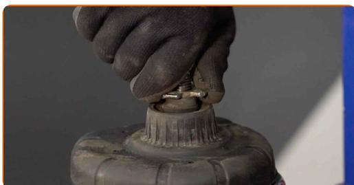
**37** Ziehen Sie die Federbeinkolbenstangenmutter an. Verwenden Sie Inbusschlüssel Nr. H6. Verwenden Sie Stecknuss Nr. 21. Verwenden Sie einen Drehmomentschlüssel. Ziehen Sie ihn mit 65 Nm Drehmoment fest.
