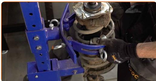
**22** Entfernen Sie die Kappe des Federbeinstützlagers. Benutzen Sie ein Brecheisen.
