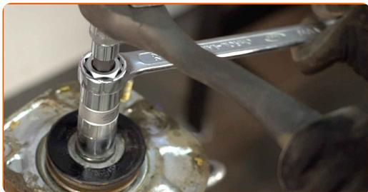
**24** Entfernen Sie die Stangenmutter des Federkolben. Verwenden Sie Inbusschlüssel Nr. H6. Verwenden Sie Stecknuss Nr. 21. Verwenden Sie einen Ratschenschlüssel.
