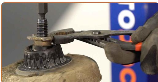
**25** Drehen Sie das Befestigungselement des Federbeinstützlagers auf. Verwenden Sie Inbusschlüssel Nr. H6. Verwenden Sie einen Ratschenschlüssel. Verwenden Sie eine Wasserpumpenzange.
