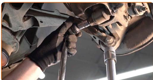
**15** Schrauben Sie das obere Befestigungselement des Stoßdämpfers ab.
