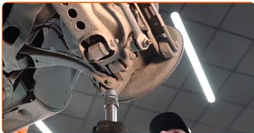
**13** Reinigen Sie die Stoßdämpferbefestigungen. Benutzen Sie eine Drahtbürste. Benutzen Sie WD-40-Spray.
