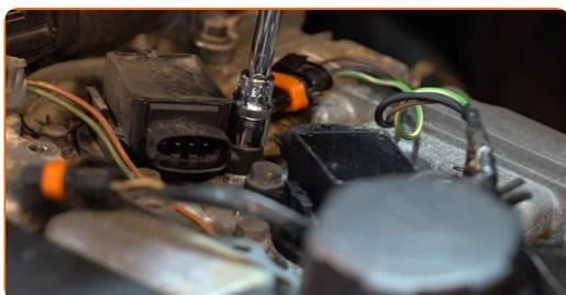
**11** Entnehmen Sie die Zündspule aus der Vertiefung für die Zündkerze.
