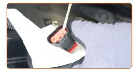
Bringen Sie den Steckverbinder des Luftmassenmessers an.
