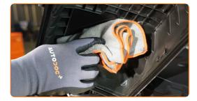
Entfernen Sie das Filterelement aus dem Filtergehäuse.
