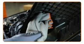
Setzen Sie die Luftfilterabdeckung wieder auf und befestigen Sie sie.
