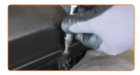
Behandeln Sie den Steckverbinder des Luftmassenmessers. Verwenden Sie dielektrisches Fett.
