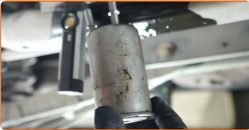
**10** Reinigen Sie die Kraftstoffleitungen. Verwenden Sie Allzweckreinigungsspray.
