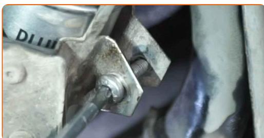
**14** Den Flüssigkeitsbehälter unter dem Kraftstofffilter entfernen.
