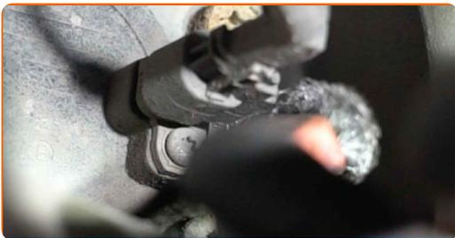
**21** Schrauben Sie die Befestigung des ABS-Sensors ab. Verwenden Sie den Torx T25. Verwenden Sie einen Ratschenschlüssel.
