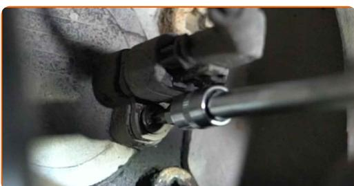
**22** Lösen Sie den ABS-Sensor.
