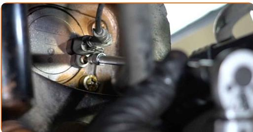
**38** Behandeln Sie die Radnabe an der Kontaktstelle mit der Bremsscheibe. Verwenden Sie Keramikfett.
