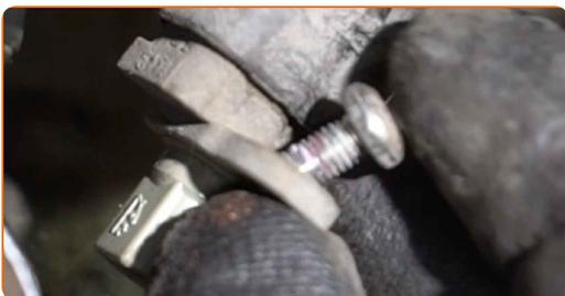
**24** Reinigen Sie die Befestigungsschrauben der Radnabe. Benutzen Sie eine Drahtbürste. Benutzen Sie WD-40-Spray.
