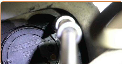
**34** Reinigen Sie den ABS-Sensor. Verwenden Sie Allzweckreinigungsspray.
