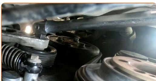
**8** Entfernen Sie den Keilrippenriemen von der Riemenscheibe.
