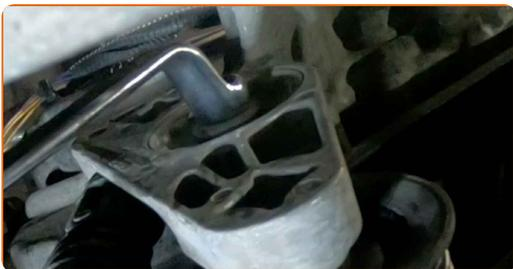
**11** Entfernen Sie die Befestigungsschrauben.
