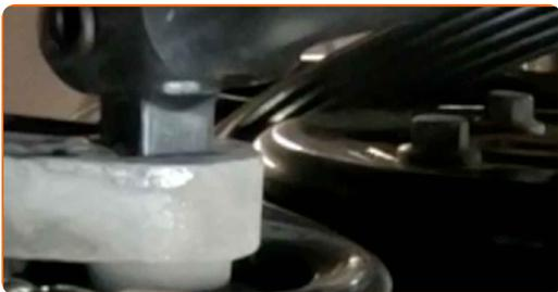
**10** Schrauben Sie die Befestigungselemente des Riemenspanners ab. Verwenden Sie Ring-Gabelschlüssel Nr. 10.
