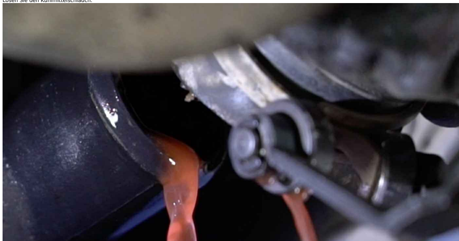
8 Lösen Sie den Kühlmittelschlauch.
