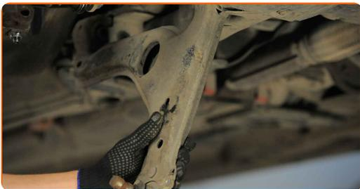
**16** Reinigen Sie die Montagebohrungen und die Gewinde des Querlenkers. Benutzen Sie eine Drahtbürste. Benutzen Sie WD-40-Spray.
