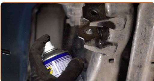
**17** Installieren Sie den Arm. Verwenden Sie einen Gummi-Hammer.
