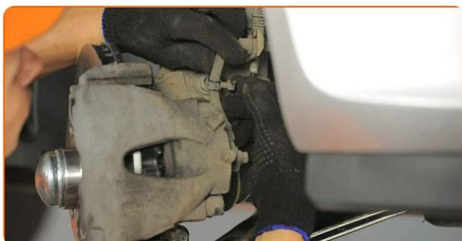
**40** Verbinden Sie das ABS mit der Sensorverdrahtung.
