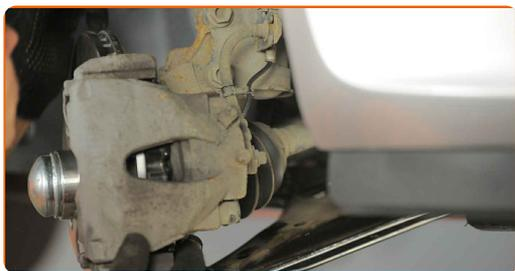
**41** Behandeln Sie das Befestigungselement, das den Spurstangenkopf mit dem Achsschenkel verbindet. Benutzen Sie ein Kupferschmiermittel.
