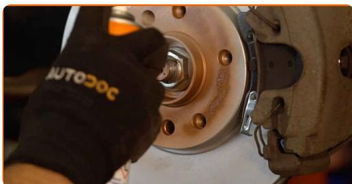
**43** Die Bremsscheibenoberfläche reinigen. Benutzen Sie einen Bremsenreiniger.
