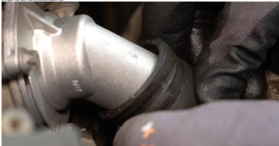
29 Schrauben Sie die Klemmen der Kühlmittelschläuche fest. Verwenden Sie eine Clic-R-Kragenzange.
