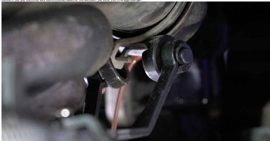
8 Lösen Sie den Kühlmittelschlauch.
