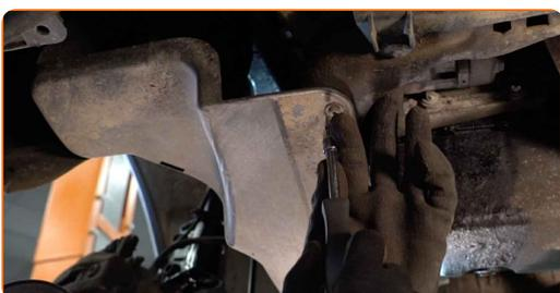
**7** Entfernen Sie die Radkastenabdeckung.
