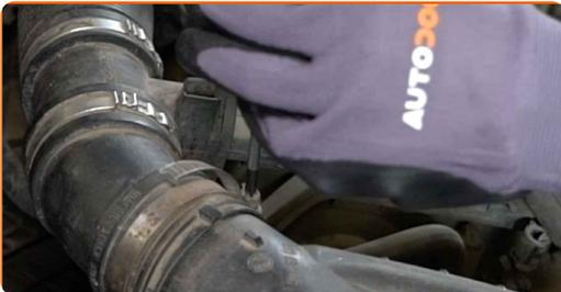
**4** Trennen Sie das Luftansaugrohr vom Luftfilter-Gehäuse.
