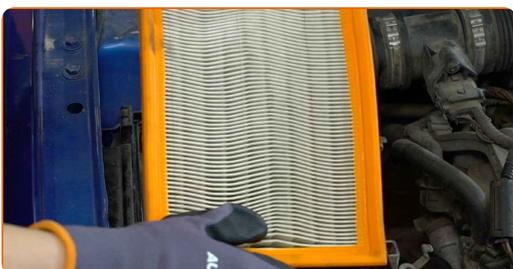
**9** Reinigen Sie die Abdeckung und das Gehäuse des Luftfilters.
