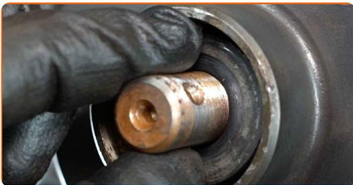
**72** Schrauben Sie die Mutter an die Gelenkwelle. Verwenden Sie Stecknuss Nr. 30. Verwenden Sie einen Ratschenschlüssel.
