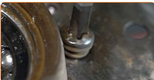
**46** Entfernen Sie das Bremsenabdeckblech.
