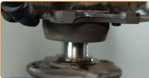
**59** Reinigen Sie die Anbringungssitze des Federbeins. Reinigen Sie den Montagesitz des Spurstangenkopfes. Die Keilwellen des CV-Gelenks der Antriebswelle reinigen. Reinigen Sie den Kugelgelenk-Montagesitz. Benutzen Sie eine Drahtbürste. Benutzen Sie WD-40-Spray. Benutzen Sie ein Kupferschmiermittel.
