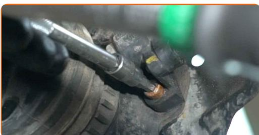
**67** Bauen Sie den Spurstangenkopf an dem Achsschenkel an.
