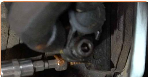
**66** Schrauben Sie die Befestigung, die den ABS-Sensor am Achsschenkel verbindet, fest. Verwenden Sie Inbusschlüssel Nr. H5. Verwenden Sie einen Drehmomentschlüssel. Ziehen Sie ihn mit 8 Nm Drehmoment fest.
