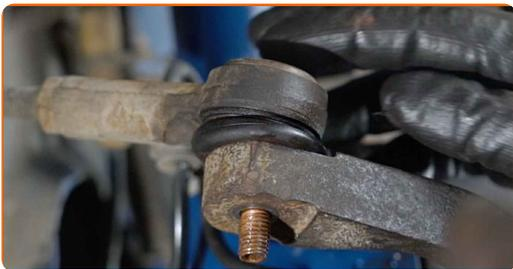
**68** Schrauben Sie die Befestigungsmutter auf, die den Spurstangenkopf mit dem Achsschenkel verbindet. Verwenden Sie Stecknuss Nr. 17. Verwenden Sie einen Ratschenschlüssel.
