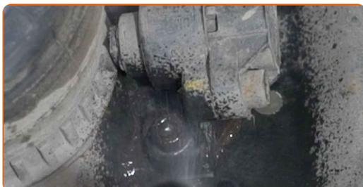
**33** Schrauben Sie die Befestigung des ABS-Sensors ab. Verwenden Sie Inbusschlüssel Nr. H5. Verwenden Sie einen Ratschenschlüssel.
