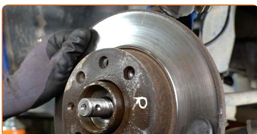
Austausch: Radlager – VAUXHALL Corsa Mk I (B) Schrägheck (S93).
