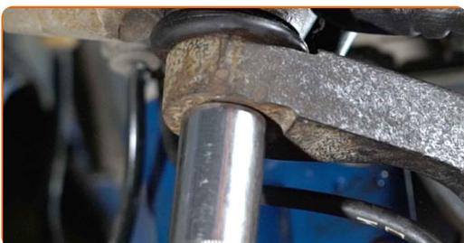
**69** Schrauben Sie das Befestigungselement ein, das das Kugelgelenk mit dem Achsschenkel verbindet. Verwenden Sie Ring-Gabelschlüssel Nr. 13. Verwenden Sie Stecknuss Nr. 13. Verwenden Sie einen Ratschenschlüssel.
