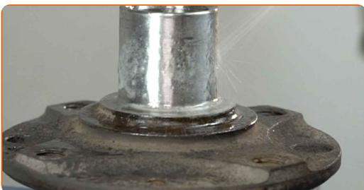
**58** Drücken Sie ein neues Lager in die Radnabe. Verwenden Sie einen Druckstücksatz mit Ein-/Auspresswerkzeug.
