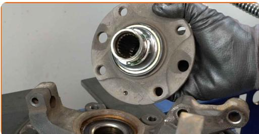
**43** Reinigen Sie den Sicherungsring des Radnabenlagers.
