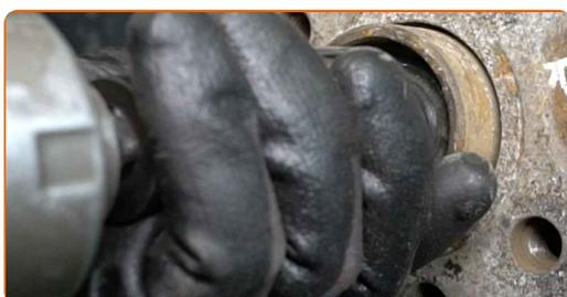
**16** Entfernen Sie die Unterlegscheibe des Radlagers. Benutzen Sie ein Brecheisen.
