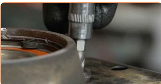
**56** Reinigen Sie den Befestigungssitz der Radnabe. Verwenden Sie Allzweckreinigungsspray.
