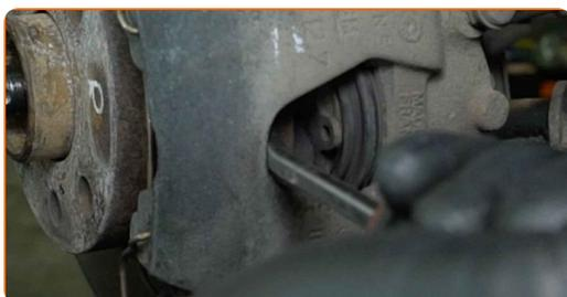
**18** Die Befestigungselemente der Bremssattelhalterung reinigen. Benutzen Sie eine Drahtbürste. Benutzen Sie WD-40-Spray.
