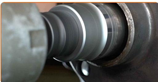
**73** Reinigen Sie die Nabe. Benutzen Sie eine Drahtbürste. Behandeln Sie die Kontaktfläche. Verwenden Sie Keramikfett.
