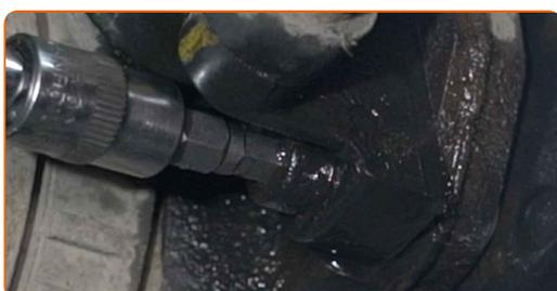
**34** Entfernen Sie die Befestigungsschraube.
