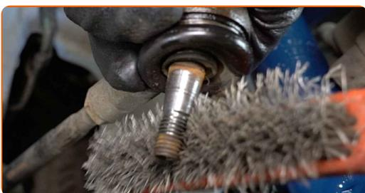
**60** Verbinden Sie das Kugelgelenk mit dem Achsschenkel.
