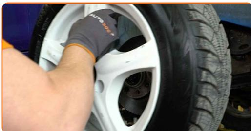
**15** Lösen Sie das Befestigungselement, welches die Antriebswelle mit der Radnabe verbindet. Verwenden Sie Stecknuss Nr. 30. Verwenden Sie einen Ratschenschlüssel.
