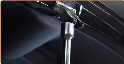
**3** Lösen Sie den Sicherungsring, der die Gasfeder mit dem Kofferraumdeckel verbindet. Verwenden Sie einen flachen Schraubendreher.
