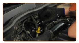
Bringen Sie den Anschluss des Kraftstoffdrucksensors an.
