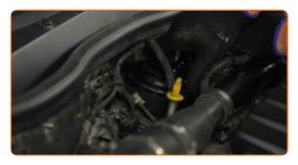
Befestigen Sie die Leitung am Kraftstofffilter.
