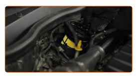
Ziehen Sie die Befestigungen des Deckels des Kraftstofffiltergehäuses an.
