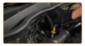
Installieren Sie einen neuen Kraftstofffilter.
