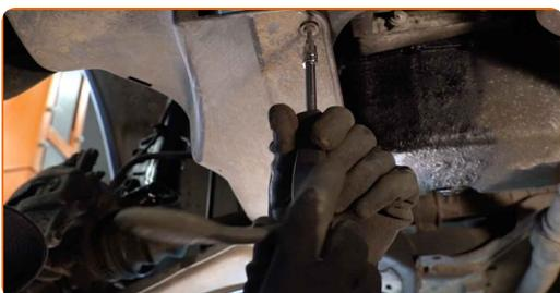
**9** Entfernen Sie die Radkastenabdeckung.
