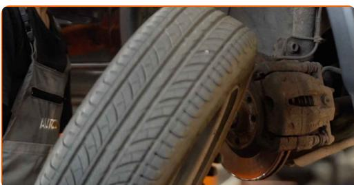
**8** Schrauben Sie die Befestigungselemente der Radkastenabdeckung heraus und entfernen Sie sie. Verwenden Sie den Torx T20.
