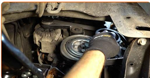
**Austausch: Keilriemen – VAUXHALL Corsa Mk II (C) Schrägheck (X01). Tipp:**
