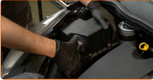
**15** Drehen Sie die Befestigungsschrauben der Luftfilter-Abdeckung ein. Verwenden Sie den Torx T20. Verwenden Sie einen Ratschenschlüssel.
