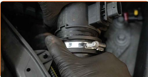
Austausch: Luftfilter – VAUXHALL Corsa Mk III (D) Schrägheck (S07).
