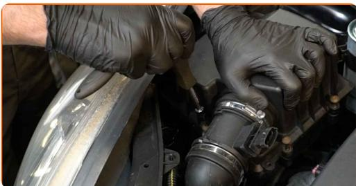
**16** Ziehen Sie die Klemme am Luftansaugschlauch fest. Verwenden Sie Stecknuss Nr. 7. Verwenden Sie einen Ratschenschlüssel.
