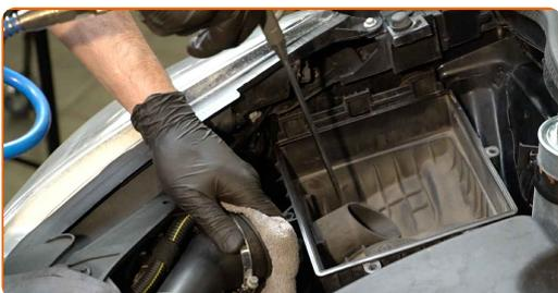
**Austausch: Luftfilter – VAUXHALL Corsa Mk III (D) Schrägheck (S07). Tipp:**
