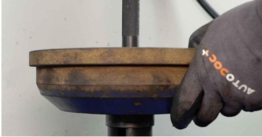
17 Reinigen Sie den Einbauort für die Nabenlagerung. Verwenden Sie Allzweckreinigungsspray.
