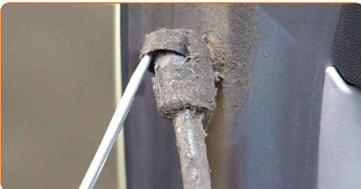
**Austausch: Heckklappendämpfer – VAUXHALL Meriva Mk I (A) (X03).
