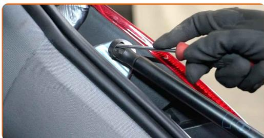
**Austausch: Heckklappendämpfer – VAUXHALL Meriva Mk I (A) (X03). Tipp:**
