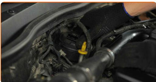
**7** Entfernen Sie die mit einer alten Filterkartusche zusammengebauten Kraftstofffilterabdeckung.
