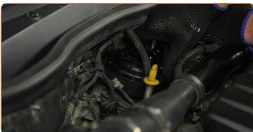
**16** Befestigen Sie die Leitung am Kraftstofffilter.
