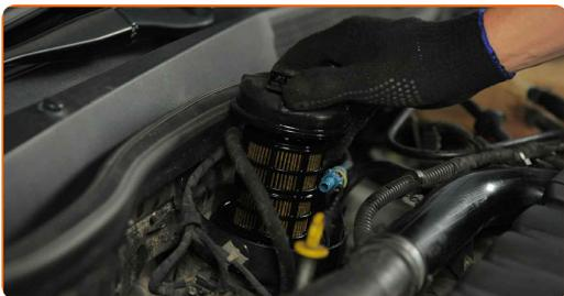
**8** Legen Sie die mit einer alten Filterkartusche zusammengebauten Kraftstofffilterabdeckung in einen Behälter.
