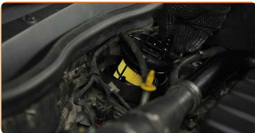
**15** Ziehen Sie die Befestigungen des Deckels des Kraftstofffiltergehäuses an.
