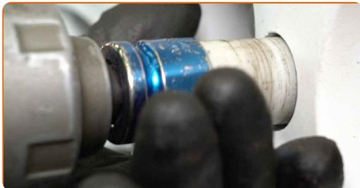
**51** Senken Sie das Auto und ziehen Sie die Radschrauben über Kreuz an. Verwenden Sie eine Schlagnuss für Felgen # 17. Verwenden Sie einen Drehmomentschlüssel. Ziehen Sie ihn mit 110 Nm Drehmoment fest.
