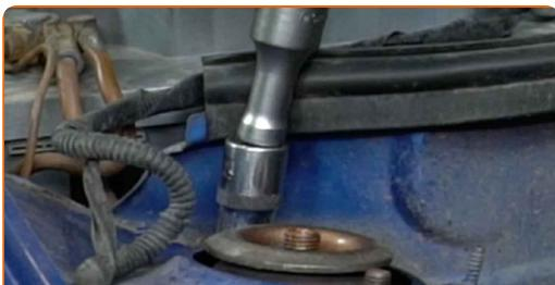
**54** Behandeln Sie die Befestigungselemente des Federbeinstützlagers. Benutzen Sie ein Kupferschmiermittel.
