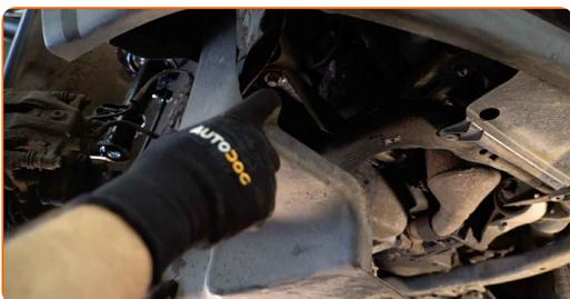
**8** Reinigen Sie alle Verbindungen des Querlenkers. Benutzen Sie eine Drahtbürste. Benutzen Sie WD-40-Spray.
