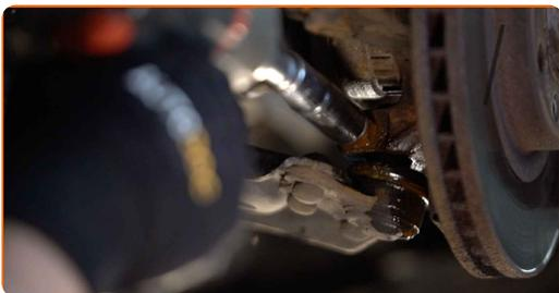
**10** Entfernen Sie die Befestigungsschraube. Verwenden Sie einen Gummi-Hammer. Verwenden Sie einen Splintentreiber.
