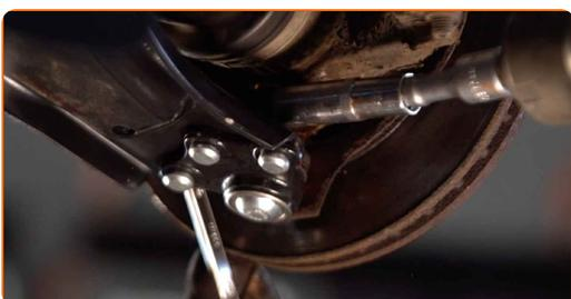
**25** Stützen Sie den Arm. Benutzen Sie einen hydraulischen Getriebeheber.
