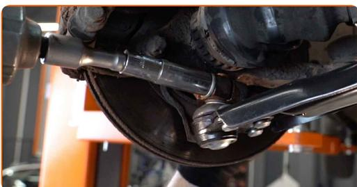
**24** Schrauben Sie die Befestigungen des Kugelgelenks ein. Verwenden Sie Stecknuss Nr. 18. Verwenden Sie Ring-Gabelschlüssel Nr. 18.
