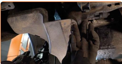
**7** Entfernen Sie die Radkastenabdeckung.
