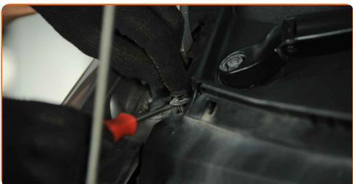
**20** Lösen Sie die Befestigungen der Frontscheibenwischerarme. Verwenden Sie Stecknuss Nr. 13. Verwenden Sie einen Ratschenschlüssel.
