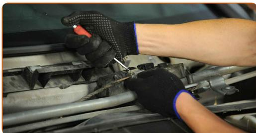
**30** Entfernen Sie die Federbeinlagerkappe. Verwenden Sie einen flachen Schraubendreher.
