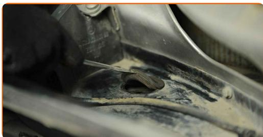
**31** Reinigen Sie die obere Befestigung des Federbeinlagers. Benutzen Sie eine Drahtbürste. Benutzen Sie WD-40-Spray.
