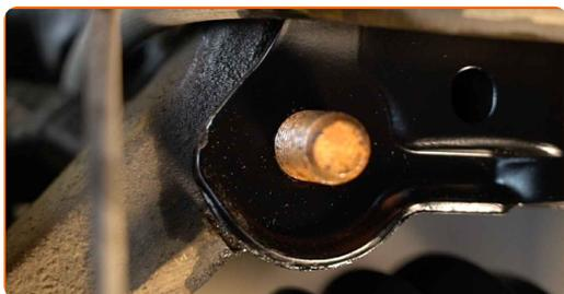
**71** Ziehen Sie die unteren Befestigungen an, die das Federbein mit dem Achsschenkel verbinden. Verwenden Sie Ring-Gabelschlüssel Nr. 21. Verwenden Sie Stecknuss Nr. 21. Verwenden Sie einen Drehmomentschlüssel. Ziehen Sie ihn mit 120 Nm Drehmoment fest.+75°
