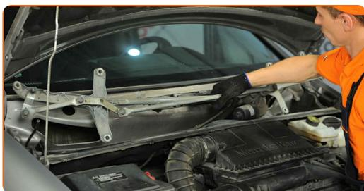
**29** Lösen Sie den Verbindungsstecker des Wischermotors. Verwenden Sie einen flachen Schraubendreher.
