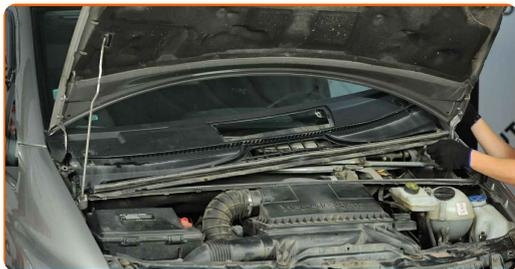
**27** Schrauben Sie die Befestigungen der Scheibenwischerverkleidung ab. Verwenden Sie Stecknuss Nr. 13. Verwenden Sie einen Ratschenschlüssel.
