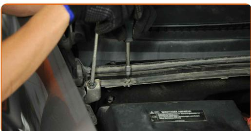
**19** Entfernen Sie die Befestigungsclips der Windlaufabdeckung. Verwenden Sie einen flachen Schraubendreher. Verwenden Sie eine Ohrklemmenzange.
