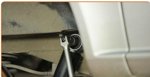
**18** Entfernen Sie den Träger unter dem Arm.
