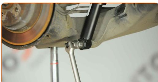
**17** Ziehen Sie die obere Stoßdämpferbefestigung an. Verwenden Sie Stecknuss Nr. 21. Verwenden Sie einen Drehmomentschlüssel. Ziehen Sie ihn mit 130 Nm Drehmoment fest.
