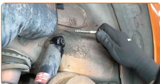
**12** Den Stoßdämpfer entfernen.
