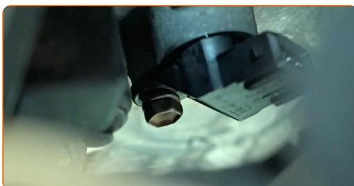
**12** Ziehen Sie die Befestigungsschraube des Nockenwellensensors an. Verwenden Sie eine Stecknuss mit einem Durchmesser von 10 mm. Verwenden Sie einen Drehmomentschlüssel. Anzugsdrehmoment: 10 N·m.
