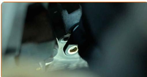
**11** Schrauben Sie die Befestigungsschraube ein.
