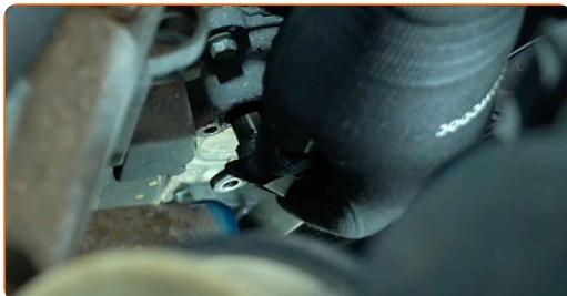
**8** Reinigen Sie den Montagesitz des Nockenwellensensors. Verwenden Sie ein Allzweck-Reinigungsspray.
