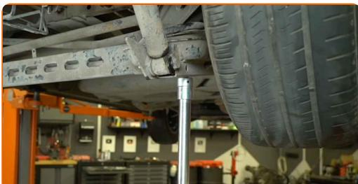
4 Lösen Sie die untere Befestigung des Stoßdämpfers und bauen Sie die Anschlagplatte aus. Verwenden Sie einen Ringmaulschlüssel mit einem Durchmesser von 21 mm. Verwenden Sie eine Stecknuss mit einem Durchmesser von 21 mm. Verwenden Sie einen Ratschenschlüssel.
