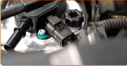
13 Verbinden Sie die Kraftstoffversorgungsleitungen zum Kraftstofffilter.
