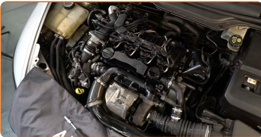
**4** Schrauben Sie die Befestigungsbolzen der Treibstofffilterhalterung ab. Verwenden Sie Stecknuss Nr. 8. Verwenden Sie Stecknuss Nr. 10. Verwenden Sie einen Ratschenschlüssel.
