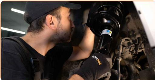
45 Schrauben Sie die obere Befestigung des Domlagers an. Schrauben Sie diese nicht fest.
