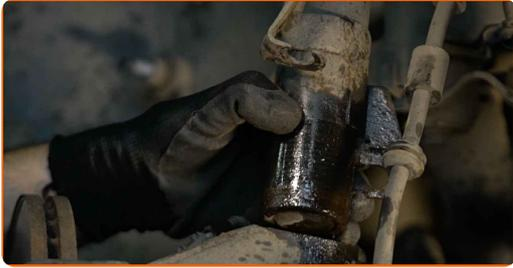
**28** Lösen Sie die obere Befestigung des Domlagers.
