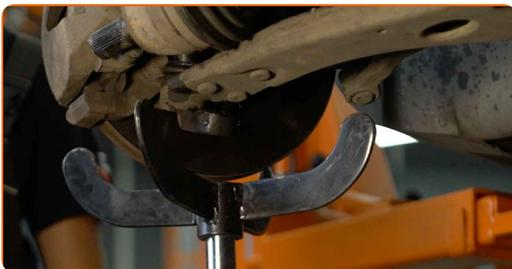
**25** Lösen Sie das untere Befestigungselement, dass das Federbein mit dem Achsschenkel verbindet. Verwenden Sie eine spezielle Schraubnuss, um den Stoßdämpfer zu entfernen. Verwenden Sie einen Ratschenschlüssel.
