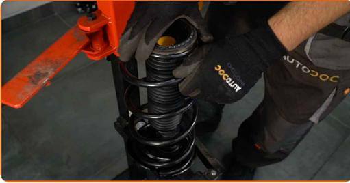
**39** Installieren Sie die Manschette und eine Stoßstopp auf den Stoßdämpfer.
