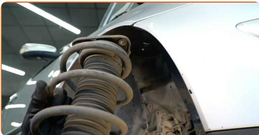
**30** Stellen Sie das Dämpferbein auf das Federspannwerkzeug.
