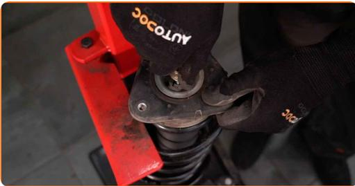
**41** Ziehen Sie die Federbeinkolbenstangenmutter an. Verwenden Sie Inbusschlüssel Nr. H6. Verwenden Sie Stecknuss Nr. 18. Verwenden Sie einen Drehmomentschlüssel. Ziehen Sie ihn mit 50 Nm Drehmoment fest.
