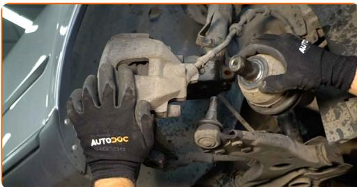
**24** Stützen Sie die Achsschenkel auf. Benutzen Sie einen hydraulischen Getriebeheber.
