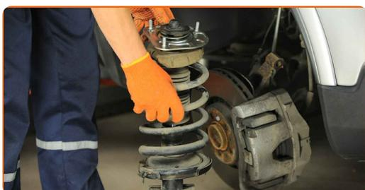
**34** Sichern Sie die oberen Befestigungen des Federbeines.
