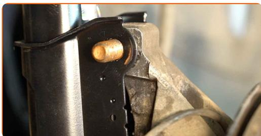
**42** Ziehen Sie die unteren Befestigungen an, die das Federbein mit dem Achsschenkel verbinden. Verwenden Sie Ring-Gabelschlüssel Nr. 18. Verwenden Sie Stecknuss Nr. 21. Verwenden Sie einen Drehmomentschlüssel. Ziehen Sie ihn mit 105 Nm Drehmoment fest.+75°
