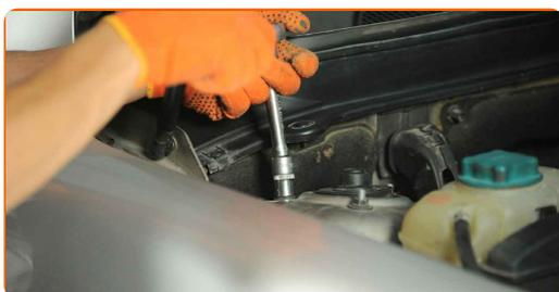
**36** Entfernen Sie die Kotflügel-Abdeckung.
