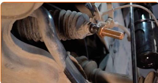
**13** Schrauben Sie einen neuen Spurstangenkopf an.
