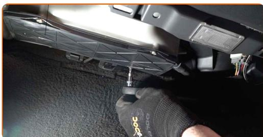
**5** Entfernen Sie den Gehäusedeckel des Innenraumfilters.
