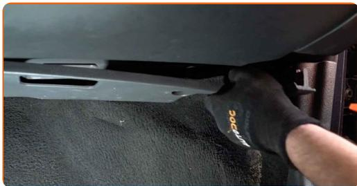
**4** Schrauben Sie die Verbindungselemente der Innenfilter-Gehäuseabdeckung ab. Verwenden Sie den Torx T20. Verwenden Sie einen Ratschenschlüssel.
