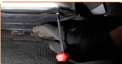
**10** Installieren und sichern Sie die Schutzabdeckung unter dem Handschuhfach.
