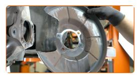
Reinigen Sie den Befestigungssitz der Radnabe. Benutzen Sie eine Drahtbürste.
