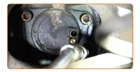
Entfernen Sie die Befestigungsschrauben.
