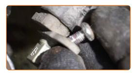
Reinigen Sie die Befestigungsschrauben der Radnabe. Benutzen Sie eine Drahtbürste. Benutzen Sie WD-40-Spray.
