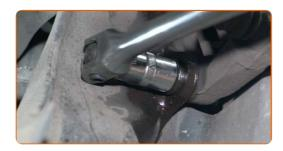
Entfernen Sie die Befestigungsschrauben.
