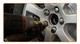
Senken Sie das Auto und ziehen Sie die Radschrauben über Kreuz an. Verwenden Sie eine Schlagnuss für Felgen # 19. Verwenden Sie einen Drehmomentschlüssel. Ziehen Sie ihn mit 140 Nm Drehmoment fest.
