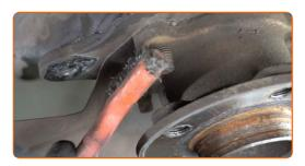
Reinigen Sie die Befestigung des ABS-Sensors. Benutzen Sie eine Drahtbürste. Benutzen Sie WD-40-Spray.
