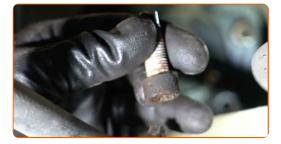
Entfernen Sie die Nabe und das Lager zusammen, da sie als Baugruppe gefertigt sind.
