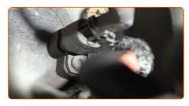
Schrauben Sie die Befestigung des ABS-Sensors ab. Verwenden Sie den Torx T25. Verwenden Sie einen Ratschenschlüssel.
