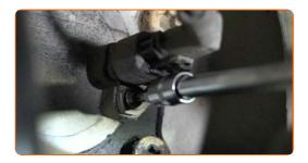
Lösen Sie den ABS-Sensor.
