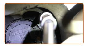
Reinigen Sie den ABS-Sensor. Verwenden Sie Allzweckreinigungsspray.
