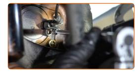
Behandeln Sie die Radnabe an der Kontaktstelle mit der Bremsscheibe. Verwenden Sie Keramikfett.
