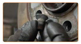
18 Entfernen Sie die Bremsscheibe.
