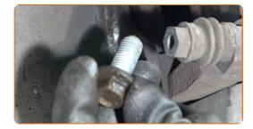
Entfernen Sie den Bremssattelhalter.
