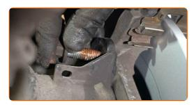
Ziehen Sie die Befestigungen des Bremssattelhalters fest. Verwenden Sie Stecknuss Nr. 15. Verwenden Sie einen Drehmomentschlüssel. Ziehen Sie ihn mit 110 Nm Drehmoment fest.
