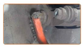
Schrauben Sie die Befestigungen des Bremssattelhalters ab. Verwenden Sie Stecknuss Nr. 15. Verwenden Sie einen Ratschenschlüssel.
