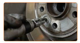
Entfernen Sie die Befestigungsschraube.
