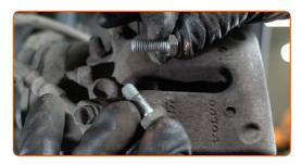
Entfernen Sie den Bremssattel.
