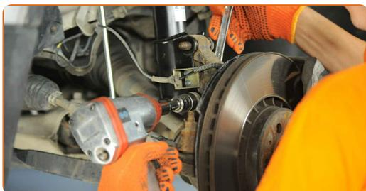
**11** Trennen Sie die ABS Sensorverdrahtung. Verwenden Sie einen flachen Schraubendreher.
