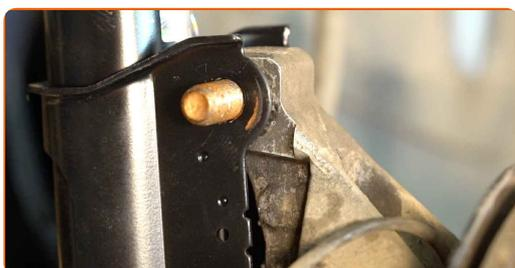
**45** Ziehen Sie die unteren Befestigungen an, die das Federbein mit dem Achsschenkel verbinden. Verwenden Sie Ring-Gabelschlüssel Nr. 18. Verwenden Sie Stecknuss Nr. 21. Verwenden Sie einen Drehmomentschlüssel. Ziehen Sie ihn mit 105 Nm Drehmoment fest.+75°
