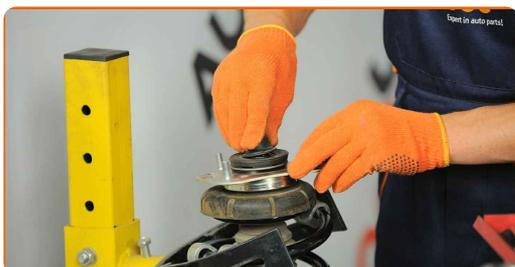
**34** Dekomprimieren Sie die Feder.
