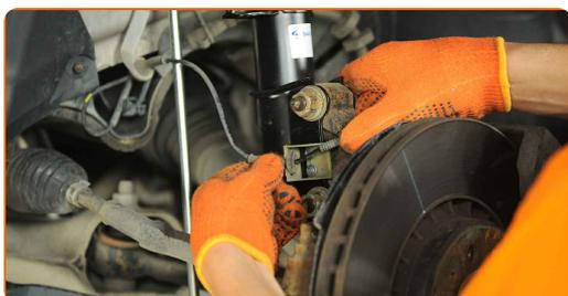
**47** Montieren Sie den Querlenker.
