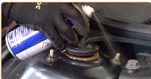
**18** Schrauben Sie das obere Befestigungselement des Federbeins ab. Verwenden Sie Stecknuss Nr. 13. Verwenden Sie einen Ratschenschlüssel.
