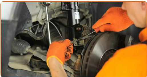
**12** Entfernen Sie die Befestigungsschrauben.
