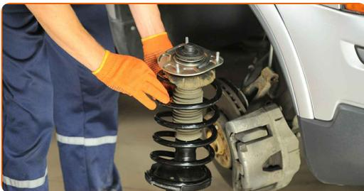
**37** Sichern Sie die oberen Befestigungen des Federbeines.
