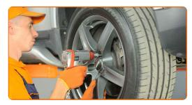
Senken Sie das Auto und ziehen Sie die Radschrauben über Kreuz an. Verwenden Sie eine Schlagnuss für Felgen 51 # 19. Verwenden Sie einen Drehmomentschlüssel. Ziehen Sie ihn mit 140 Nm Drehmoment fest.
