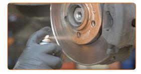
Die Bremsscheibenoberfläche reinigen. Benutzen Sie einen Bremsenreiniger.
