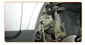
Die Befestigungselemente, die das Federbein mit dem Achsschenkel verbinden, reinigen. Benutzen Sie eine Drahtbürste. Benutzen Sie WD-40-Spray.
