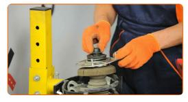
Entfernen Sie das zusammengebaute Federbein.
