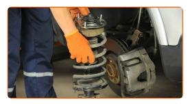
34 Sichern Sie die oberen Befestigungen des Federbeines.
