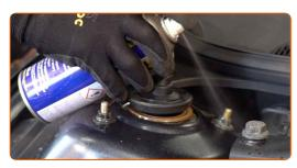
Schrauben Sie das obere Befestigungselement des Federbeins ab. Verwenden Sie Stecknuss Nr. 13. Verwenden Sie einen Ratschenschlüssel.
