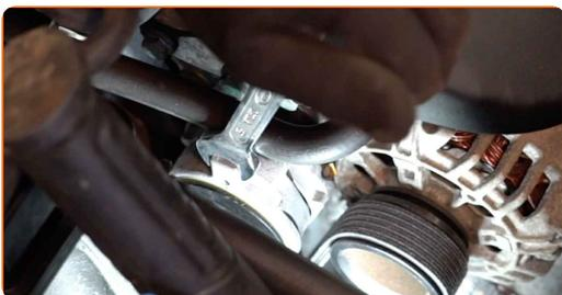
**11** Entfernen Sie den Keilrippenriemen.
