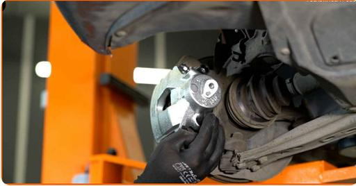
27 Entfernen Sie den Schmutz von der Schraube zur Befestigung des Bremsschlauchs. Benutzen Sie einen Bremsenreiniger.
