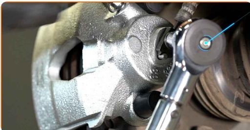
**Austausch: Bremssattel – VW Bora Limousine. Tipp von AUTODOC:**
