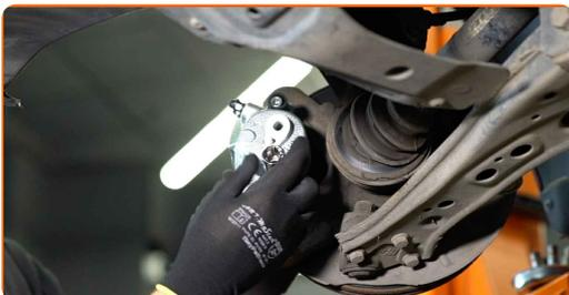
26 Installieren Sie die Staubschutzkappen der Bremssattel-Führungsstifte.
